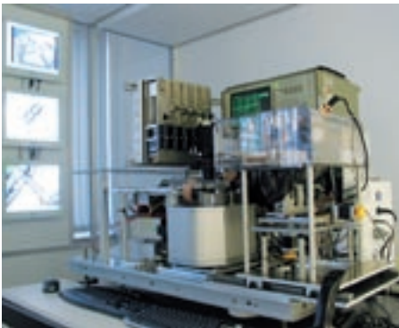
Abbildung 4: »NazcaLab«: Mikrosystemtechnische Realisierung eines Stammzell-Differenzierungsautomaten unter Vermeidung jedweder artifizierlicher Oberflächenberührungen mittels Hochfrequenzfeldern.
