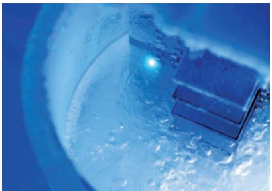
Tieftemperaturtaugliche Elektronik in flüssigem Stickstoff.
