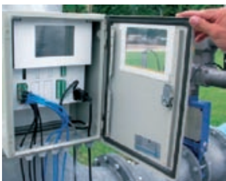
Abbildung 5: Deltawave mit geöffnetem Gehäuse.
