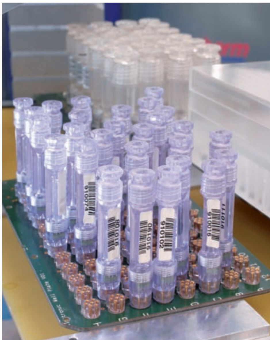
Im Tiefkühlschrank elektronisch ansteuerbare Substrate mit Barcode und jeweils einem elektronischen Speicherchip.
